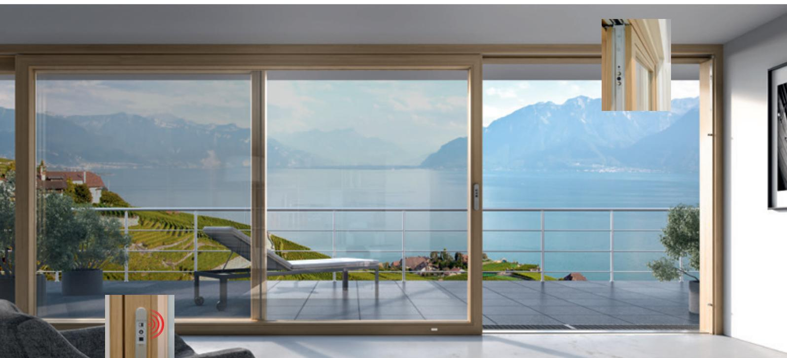
Alle Bauteile des HS ePOWER sind verdeckt im Hebeschiebeflügel. Die drei Tastenfelder des manuellen Bedienelements haben eine selbsterklärende Symbolik und sind intuitiv bedienbar.
