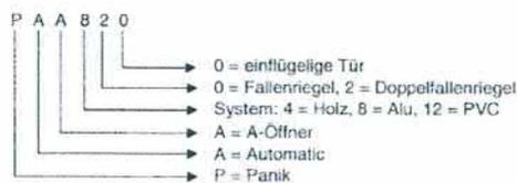
Die Schlosstypen PA 400 – 1220 und Security 1910 – 1919S können mit autarker Zusatzfalle am Langstulp in Kombination mit Fluchttüröffner EFF-EFF 332 als elektrisch verriegeltes Panikschloss (Security EVP) betrieben werden. Panikfunktion nur bei freigeschaltetem (spannungslos) Türöffner EFF-EFF 332 gewährleistet. (Dann nur VS-TYP B).
