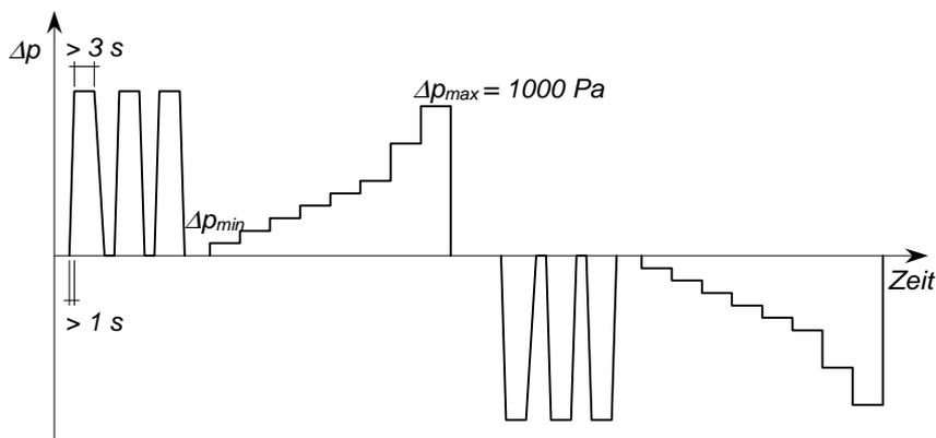
Abbildung 2 Prüfung Luftdurchlässigkeit bei Über- und Unterdruck
