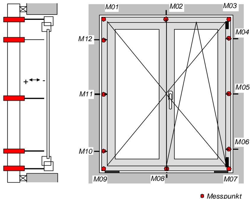
**Bild 3** Schematische Darstellung der Position der Befestigungspunkte und der Linearpotentiometer
