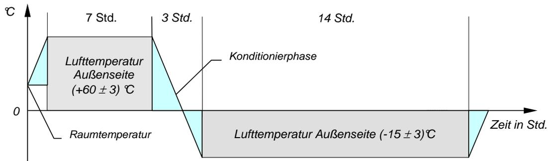
**Abbildung 3** Darstellung der Temperatur-Wechselbelastung für einen Zyklus
