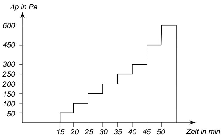
Abbildung 1 Darstellung der Druckstufen und des zeitlichen Verlaufes
