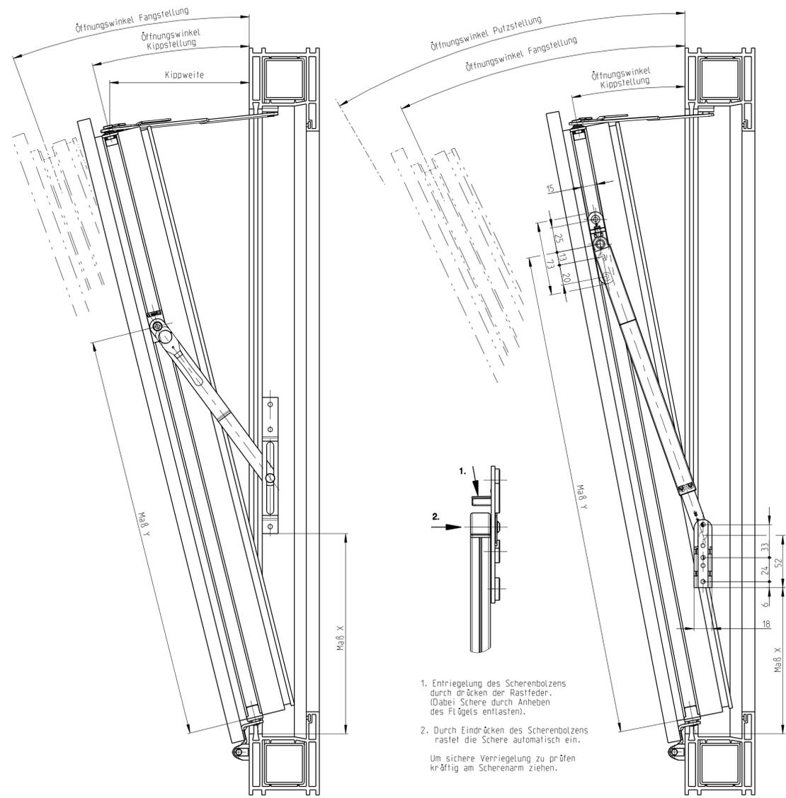
1. Entriegelung des Scherenbolzens durch drücken der Rastfeder. (Dabei Schere durch Anheben des Flügels entlasten).
