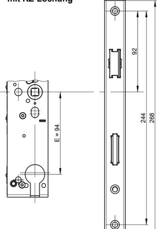
**Flügelfräsung für Schlosskasten Serie 13**
