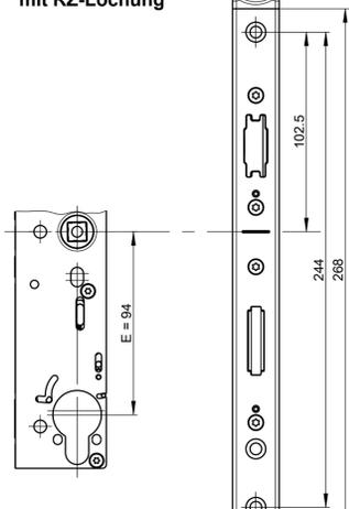
**Flügelfräsung für Schlosskasten Serie 18**
