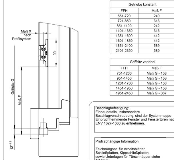
Beschlagbefestigung: Einbaudetails, insbesondere Beschlagerschraubung, sind der Systemmappe Einbruchhemmende Fenster und Fenstertüren nach ENV 1627-1630 zu entnehmen.
