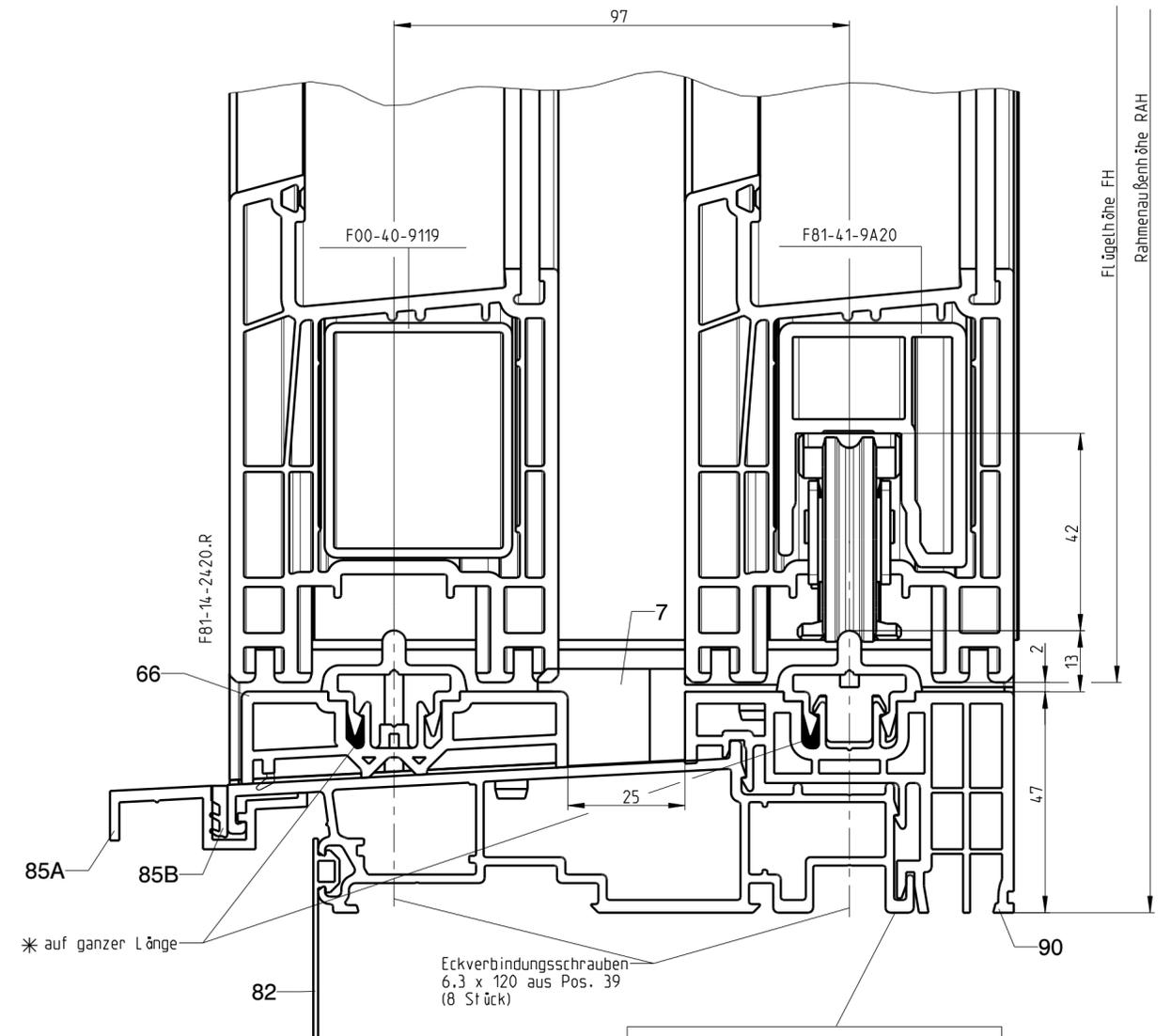
Bei der Montage des Elements ist auf eine sorgfältige Unterfütterung der Bodenschwelle zum Baukörper zu achten. Der Abstand der einzelnen Befestigungspunkte soll ca. 500 mm betragen. Ab 250 kg Flügelgewicht soll der Abstand max. 300 mm betragen.
