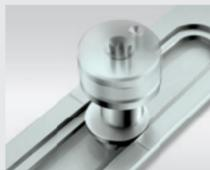
Le galet automatique Cleverle compense des tolérances de jeu en feuillure de 8,5 à 15 mm en liaison avec la gâche standard : pour un montage et une maintenance simplifiés.
