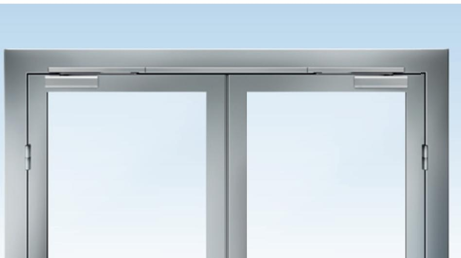
Grâce à la simplicité du montage et une extrême sécurité de fonctionnement, les ferme-portes en applique OTS peuvent être montés côté paumelles ou côté opposé. L'utilisation sur des portes à deux vantaux est également possible. Un système de sélection de fermeture intégré dans la glissière et invisible assure l'ordre de fermeture correct des vantaux actif et passif.
