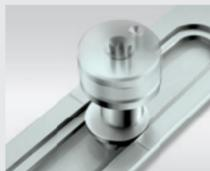
Il perno fungiforme autoregolante Cleverle compensa in modo ottimale l'aria in battuta da 8,5 a 15 mm in combinazione con scontri standard: per un'installazione e una manutenzione semplificata.
