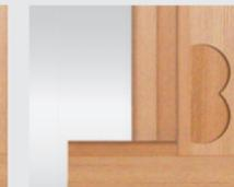
Schema di fresatura nel telaio in legno per UNI-JET M 6/12: doppia tazza fresata su spezzone non incollato per il montaggio di singoli pezzi.
