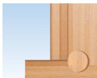
Schema di fresatura UNI-JET M20/12
