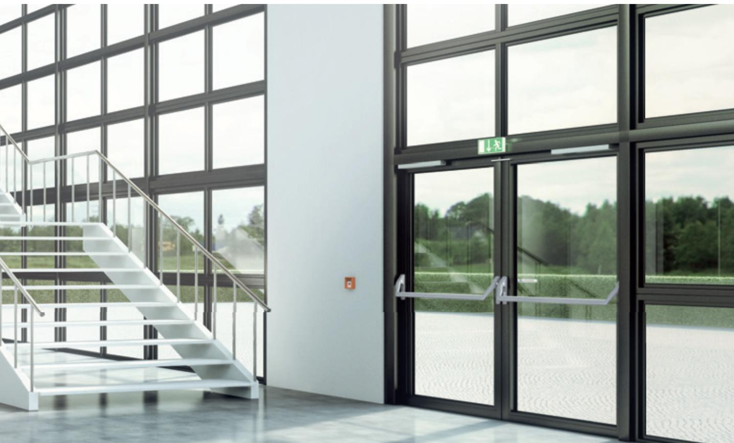
Per un funzionamento sicuro ed efficace dell'evacuazione di fumo e calore sono necessarie aperture di ingresso aria vicine al pavimento con le corrette dimensioni. Con una specie di "effetto camino" esse rafforzano la spinta termica verso l'alto, garantendo quindi una salita e un'espulsione più rapida delle quantità di gas combusto.
