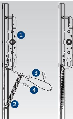
Montaggio della molla di trazione per semplificare l'azionamento della maniglia per pesi anta > 200 kg
