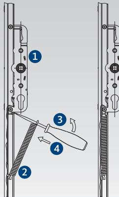
Ugradnja opruge za olakšavanje pokretanja pogonske ručke za mase krila > 200 kg
