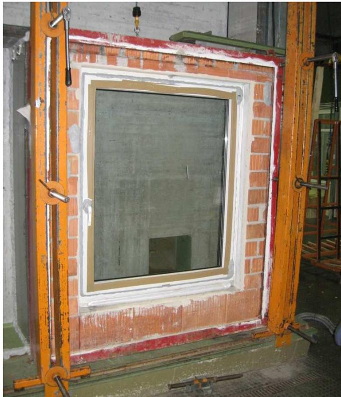
**Bild 1** Probekörper aufgebaut auf dem Fensterprüfstand
