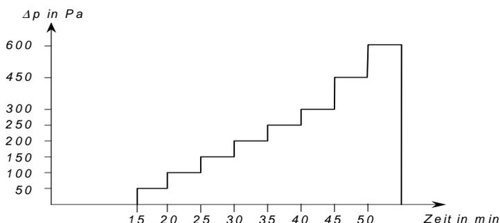
**Abbildung 4** Darstellung der Druckstufen und des zeitlichen Verlaufes
