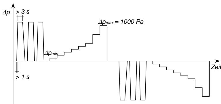
**Abbildung 1** Prüfung Luftdurchlässigkeit bei Über- und Unterdruck
