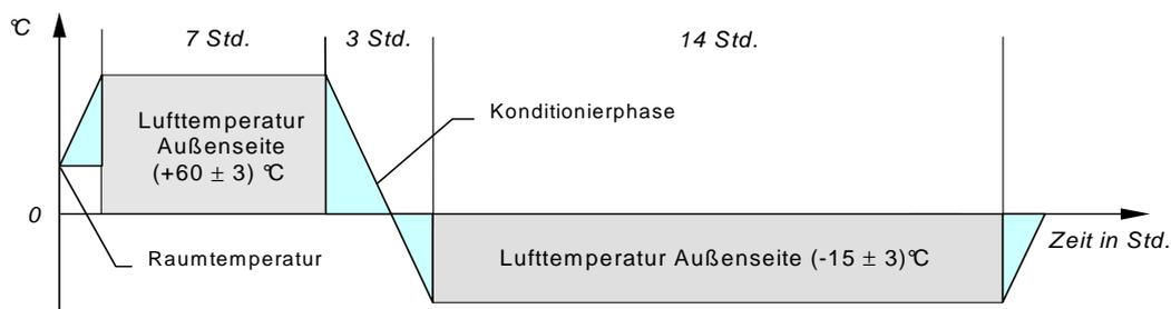
**Abbildung 2** Darstellung der Temperatur-Wechselbelastung für einen Zyklus
