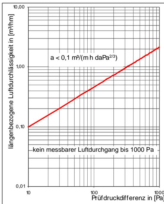
**Diagramm 1** Längenbezogene Luftdurchlässigkeit bei Überdruck
