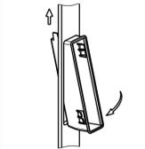
Abdeckgehäuse in Schließblech einsetzen.
