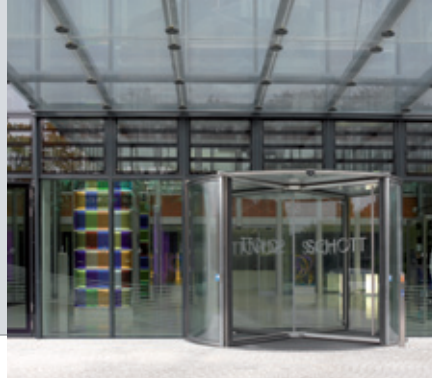
Schott AG | MAINZ | J • S • K Architekten | Typ GGG | vollautomatisch | 4-flügelig | edelstahlbeplankt | Nachtverschluss | Unterflurantrieb
