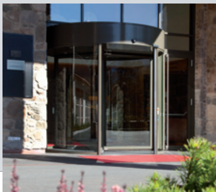
HOTEL GRAND TIROLIA | KITZBÜHEL | Peter Weber Architekten | Typ GRA | vollautomatisch | mit eingebautem Warmluftschleier | Kranzblende durchgehend | Blendenhöhe 450 mm | ø 3000 mm
