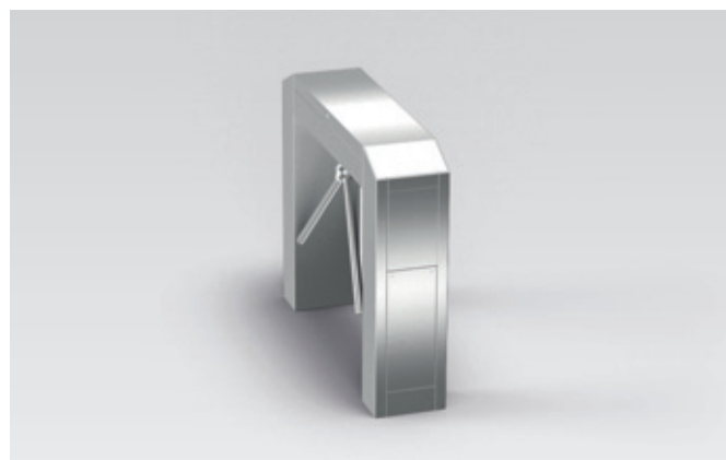
Zweiarm-Drehsperre in Freigabeposition: Per Knopfdruck durch den Pförtner oder bei Alarm dreht sich der Stern unter das Gehäuse. Der Zugang oder der zusätzliche Fluchtweg werden freigegeben. Das Wiederherstellen des Normalbetriebs erfolgt schnell und unkompliziert wiederum per Knopfdruck.
