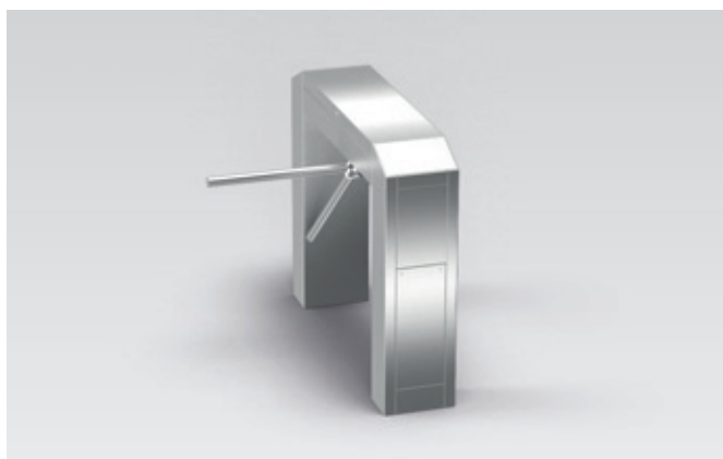
Zweiarm-Drehsperre im Normalbetrieb: Die elektrische Bremse hält den Drehstern in gesperrter Stellung. Durch leichten Druck wird der Antrieb ausgelöst und dreht den Stern um 120° oder 240° weiter.
