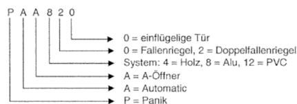
Die Schlosstypen PA 400 – 1220, GU-SECURY Automatic-DRP und Security 2116 – 2119 S können mit autarker Zusatzfalle am Langstulp in Kombination mit Fluchttüröffner EFF-EFF 332 als elektrisch verriegeltes Panikschloss (Security EVP) betrieben werden. Panik nur bei freigeschaltetem (spannungslos) Türöffner EFF-EFF 332 gewährleistet. (Dann nur VS-TYP B).
