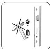
**Die Kennkerbe des Schlossstulpes muss mit der Kennkerbe von Schließleiste/Schließblech fluchten! Sollte keine Kennkerbe vorhanden sein, wird die Falle am Schlossstulp mit der Fallenausparung an Schließleiste/Schließblech ausgerichtet!**
