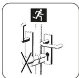
Bei Fluchttürverschlüssen dürfen keine Schließzylinder mit Knauf oder Drehknopf eingebaut werden!
