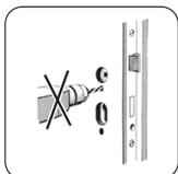
**Im Bereich von Stromleitungen darf nicht gebohrt werden!**
