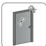
**Nach den abgeschlossenenen Montagearbeiten an der Tür muss über Falzlufbegrenzer gewährleistet sein, dass sich Flügel und Rahmen auf dem Transportweg nicht gegeneinander bewegen können (die Verriegelungspunkte könnten beschädigt werden)!**
