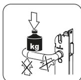
**Der Drücker darf nur im vorgesehenen Drehsinn belastet werden. In Betätigungsrichtung darf auf den Drücker maximal nur eine Kraft von 150 N aufgebracht werden!**
