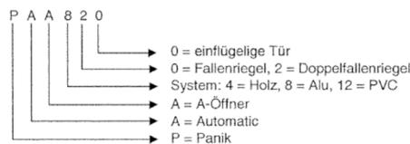
Mehrpunktverriegelungen können wahlweise mit Automatik-Rundriegel Ø11mm oder Flachfallenriegel ausgestattet sein.
